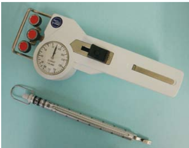
Fadenspannungsmessgerät und Federwaage zur Überprüfung der Fadenspannungen an der Nähmaschine
