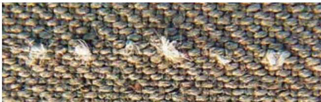
Materialschäden durch Nadeleinstich
