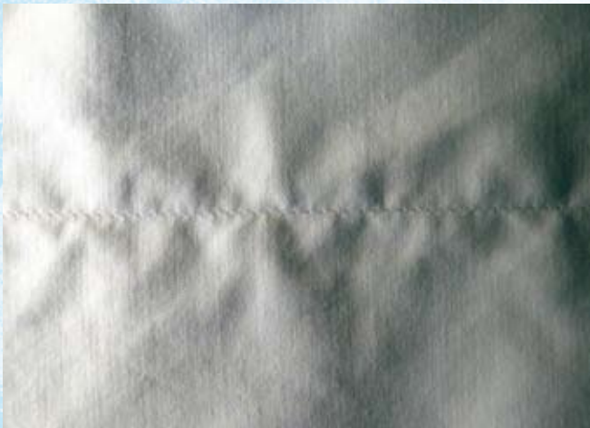
Unakzeptable Nahtoptik aufgrund zu hoher Fadenspannung
